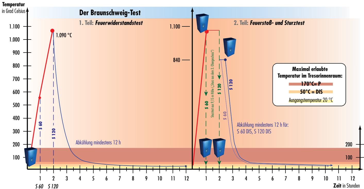
Hat ein Tresor den Test bestanden, erhält er eine dieser Feuerschutzklassen:
