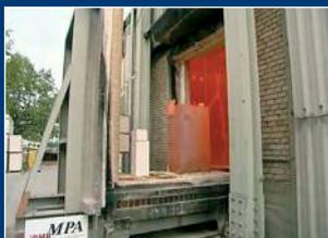
Anschließend wird er aus 9,15 m Höhe auf ein Kiesbett gestürzt. Das entspricht einem Sturz aus dem 3. Stockwerk eines brennenden Gebäudes.
