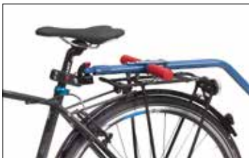
Fahrradkupplung 1298 Für Handwagen 4103 – 4105 und 4107 – 4109. Anbausatz bestehend aus Kugelkupplung und Adapter für Sattelstützen von 26 bis 31 mm Durchmesser und Kugelschale mit Anschraubplatten an Standarddeichsel. Zuladung max. 40 kg Aufliege­last max. 4 kg. Nachrüstbar.
